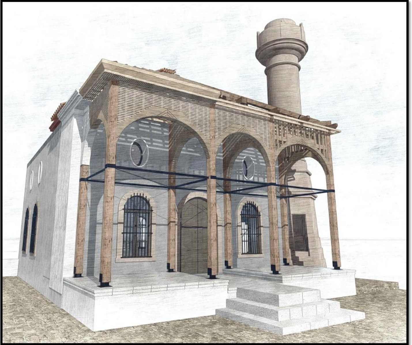
Εικόνα 8 - Τρισδιάστατη απεικόνιση ξύλινου προστώου (βόρεια όψη)
