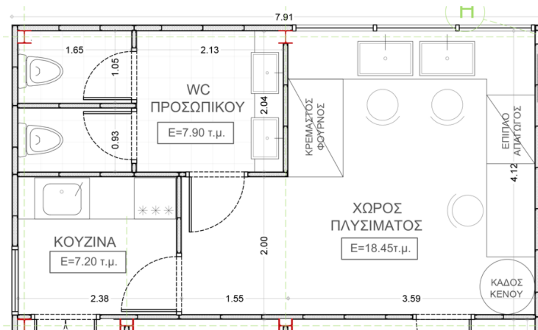
Εικόνα 6: Χώροι ορόφου (WC και κουζίνα) στους οποίους θα πραγματοποιηθεί επικάλυψη με πλακίδια,
